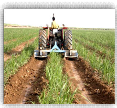
شکل ۵. وجین مکانیزه با استفاده از ادوات هیلینگ آپ (جابجای جوی و پشته) در مزارع نیشکر
