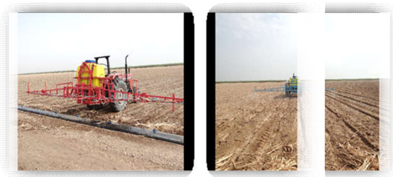
شکل ۶. سمپاش‌های پشت تراکتوری مخصوص مزارع نیشکر
