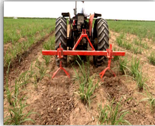
شکل ۴. وجین مکانیزه با استفاده از کولتیواتور قالبی در مزارع نیشکر
