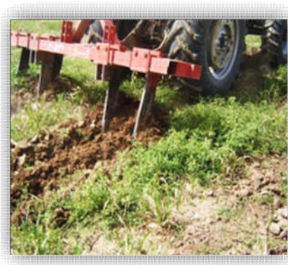
شکل ۵. وجین مکانیزه با استفاده از ادوات هیلینگ آپ (جابجای جوی و پشته) در مزارع نیشکر
