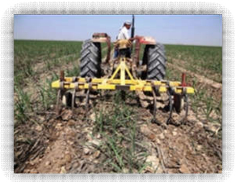
شکل ۲. وجین مکانیزه با استفاده از کولتیواتور پنجه‌غازی در مزارع نیشکر
