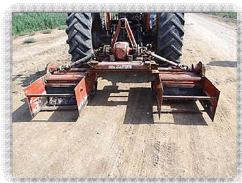
شکل ۳. وجین مکانیزه با استفاده از روتیواتور در مزارع نیشکر
